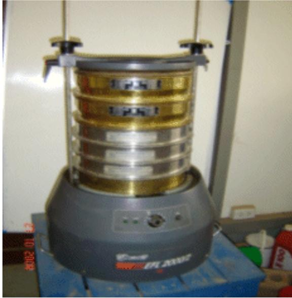
**Figure 4-2 : Tamiseuse électrique.**
