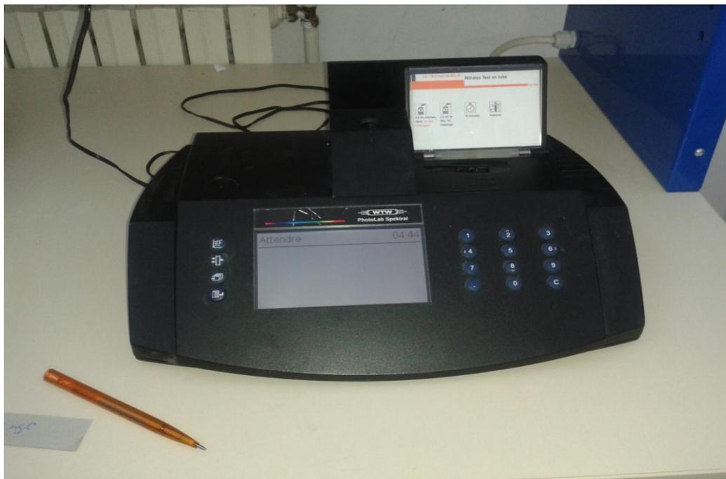
Photo réelle Spectrophotomètre UV visible « photolab spektral »
