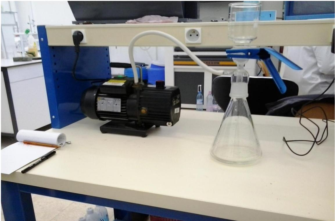
**Photo réelle de l'installation expérimentale de mesure des MES**
