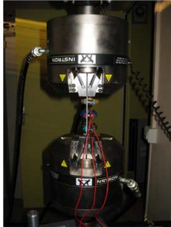
**Figure 1.13.** Essai de traction instrumenté en capteurs d'émission acoustique.
