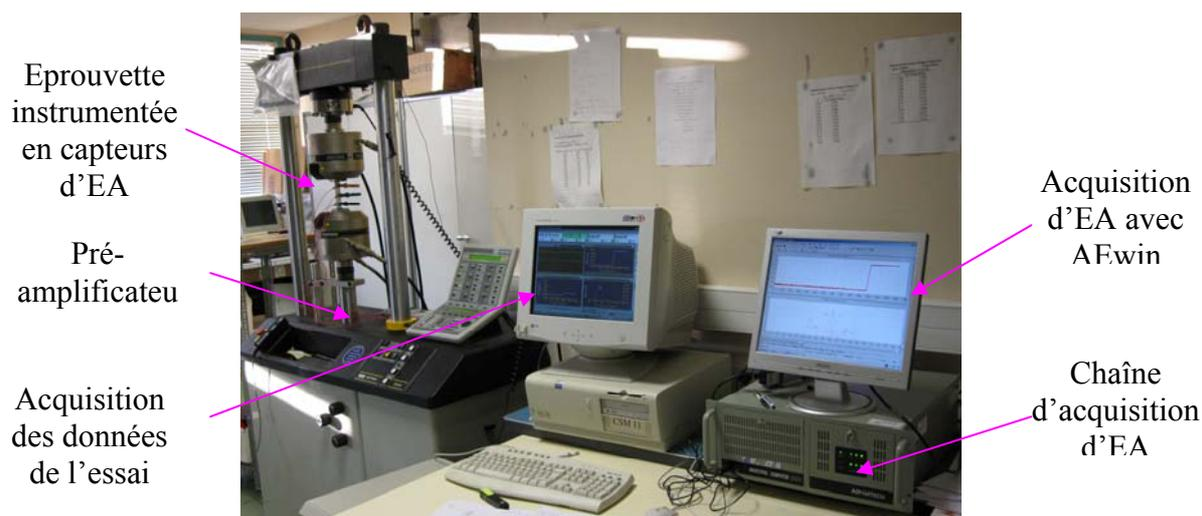
**Figure 2.14.** Banc d'essais et acquisition des signaux acoustiques.
