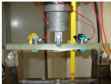
**Figure 1.7.** Principe d'essai de flexion 3 points instrumenté de capteurs d'EA.
