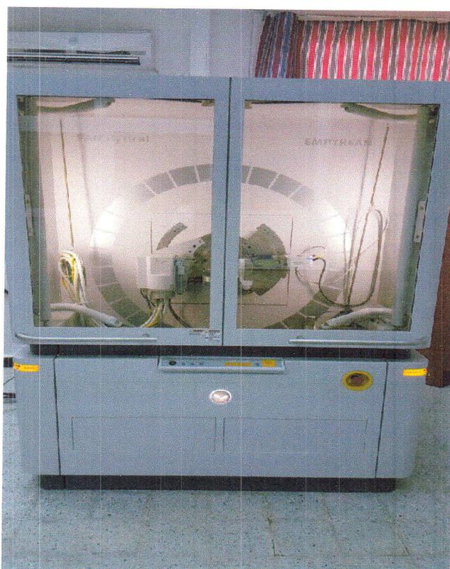
**Figure II.12** : Le diffractomètre utilisé de type : PANalytical EMPYREAN
