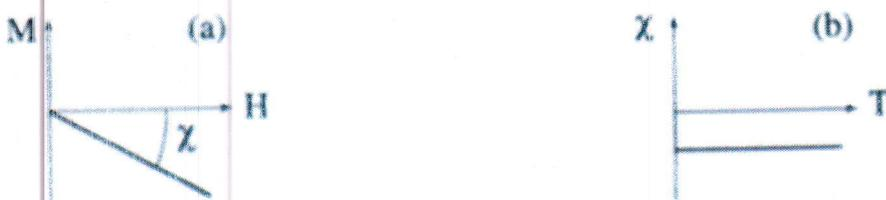
Figure 1. Le diamagnétisme : (a) variation sous champ magnétique de l'aimantation, (b) variation thermique de la susceptibilité magnétique [2].
