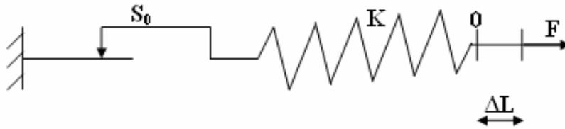
**Figure 3.4.** Modèle unidimensionnel du comportement élastoplastique.
