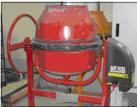
Photo III-3. La bétonnière utilisée.
