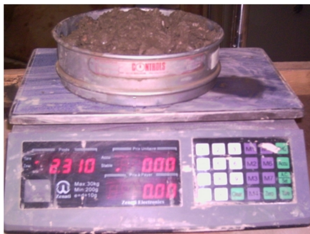
Figure I.18 :Les différentes étapes de l'essai de mesure de l'indice de ségrégation statique
