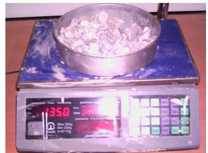
Photos (III.7).Les différentes étapes de l'essai de mesure de la résistance à la ségrégation.
