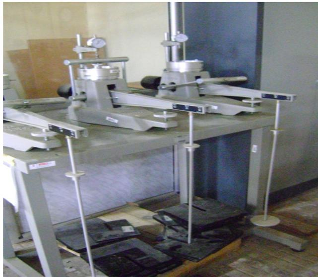
**Photo 07:** Vue générale de l'oedomètre au cours de l'essai
