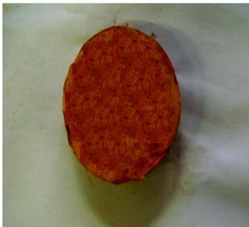
**Photo 03 Echantillon d'argile de Guelma après l'essai de consolidation**
