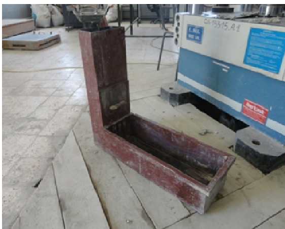
Figure III.13. Boite en L utilisé
