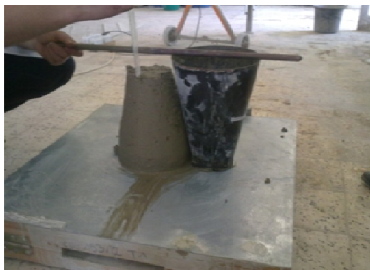
Figure III.10. Essai d'affaissement au cône d'Abrams
