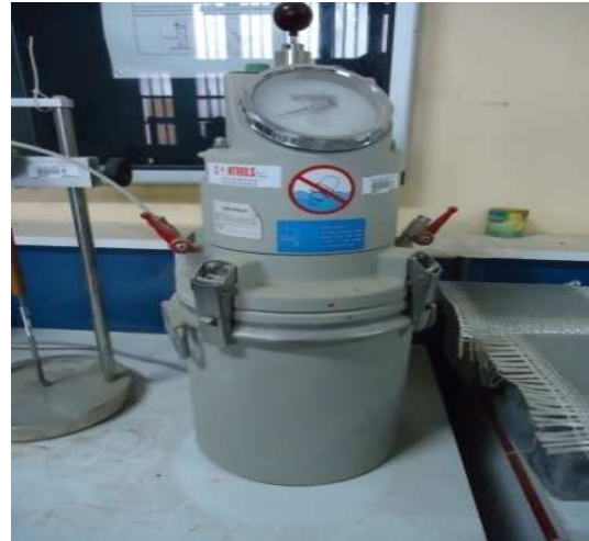
Figure III.2. Aéromètre à béton utilisé
