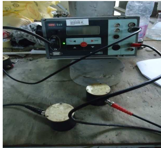
Figure III.4. Appareil utilisé pour l'essai d'ultrasons
