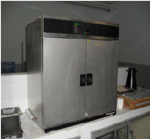
Figure III.3. Etuve utilisé pour le traitement thermique
