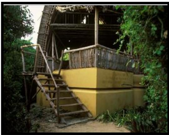
Les bases des bâtiments sont faites de maçonnerie, en utilisant des roches de corail fossilisé de roche de locad creusées du site. Tous les principaux composants structurels sont des poteaux de casuarina.
