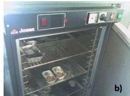
Figure.V.8 a) et b) Séchage des échantillons dans l'étuve
