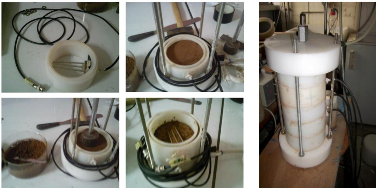
Figure V.19. Montage de la colonne du limon de Florensac
