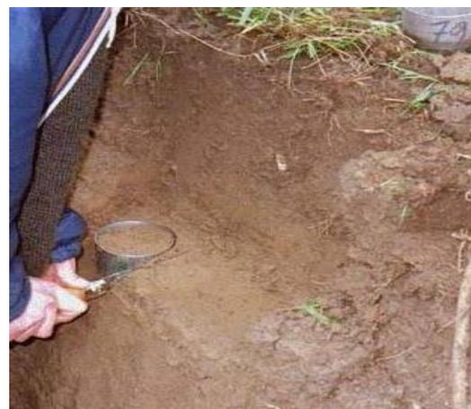
Figure I.25. Prise d'échantillon par la méthode des cylindres.
