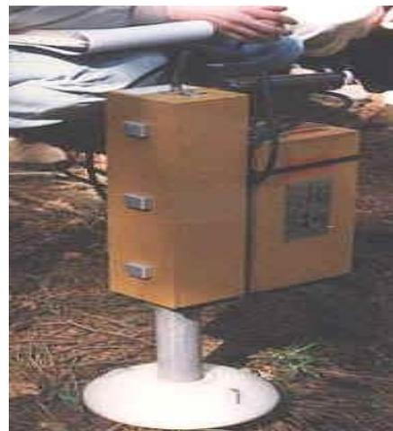
Figure I.26.b). Sonde neutronique employée sur le terrain.
