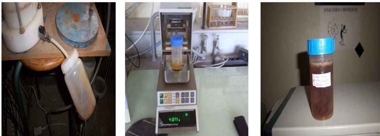
Figure V.20. Mesure de la quantité d'eau sortante
