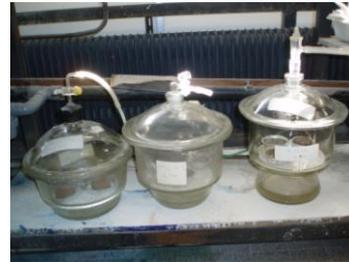
Figure. V.7 c) Dessiccateurs bien fermés pour éviter tout contact avec l'extérieur
