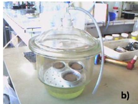
Figure.V.9 a) et b) Pose des échantillons séchés dans le dessiccateur.
