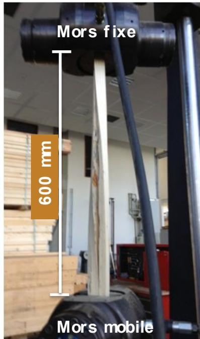
Figure II.11. Dispositif d'essais de torsion
