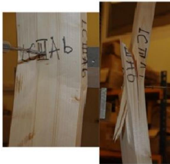
Figure III.6. Rupture de la lamelle la plus faible pour le LC
