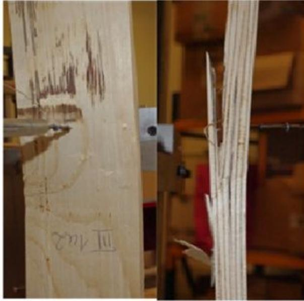
Figure III.5. Décollement des lamelles de la zone tendue du LVL
