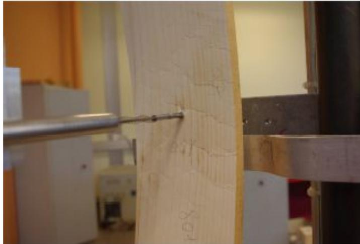
Figure III.3. Endommagement par compression avant rupture par traction
