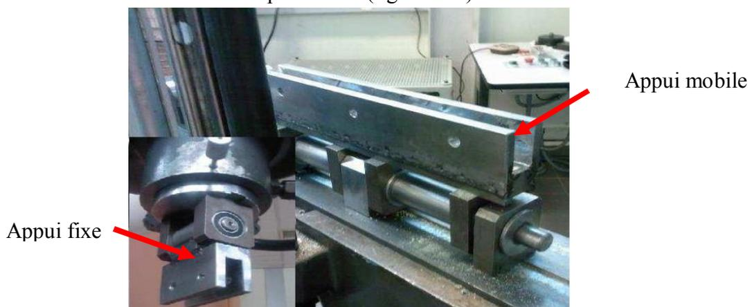
Figure II.1. Premier dispositif de flambement
