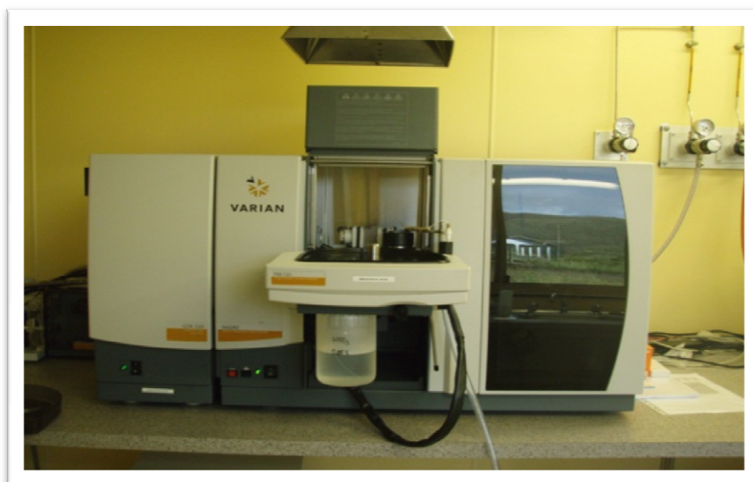
Photo VII.02 –Le spectrophotomètre d'absorption atomique (SAA) 800
