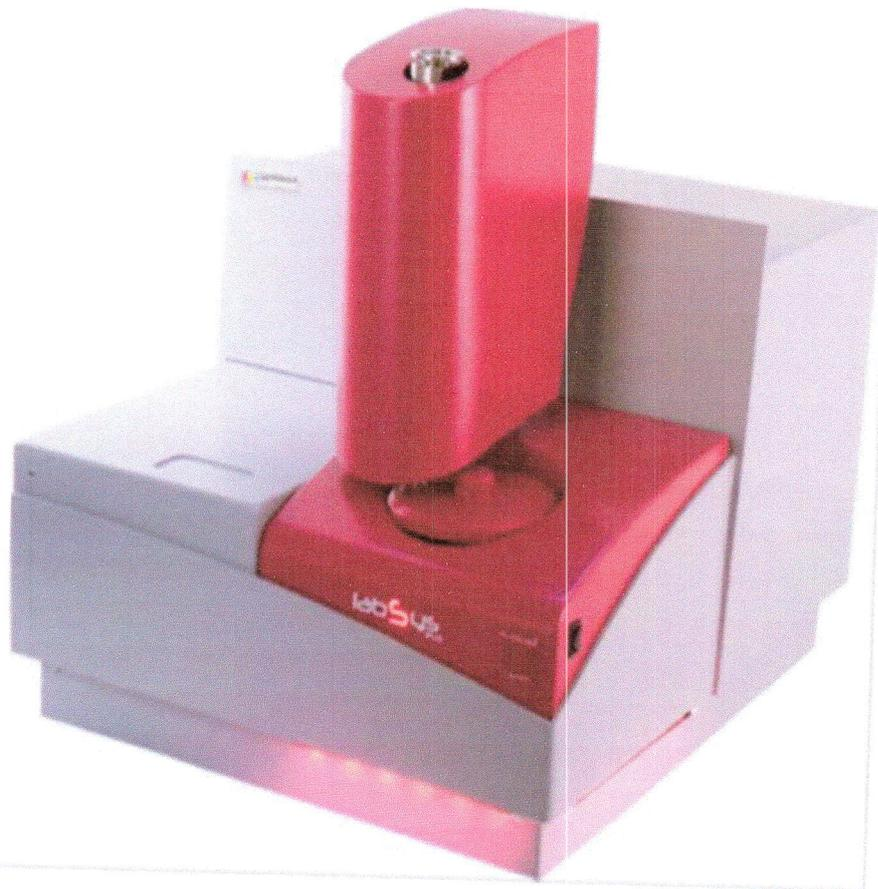
**Figure. 3. 4. L'appareil d'analyse calorimétrique différentielle à balayage utilisée (DSC SETARAM)**
