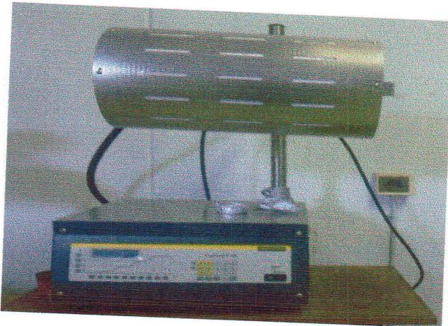
Figure II.2.2 : Four (tubulaire) qui a servi au traitement thermique.
