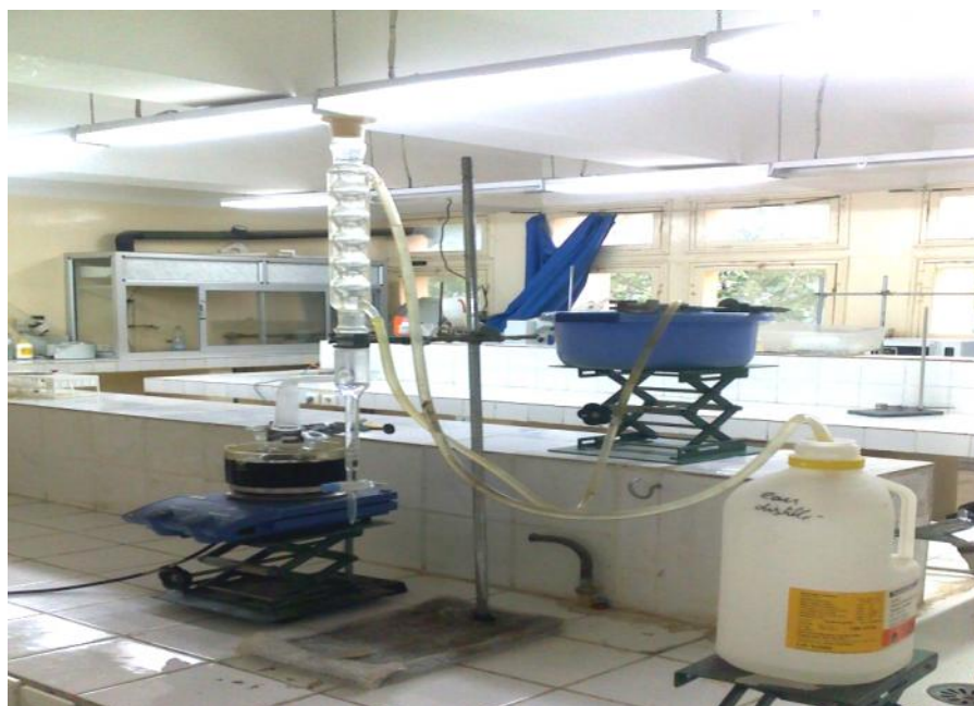
Figure IV.2. Montage utilisé pour la synthèse des esters
