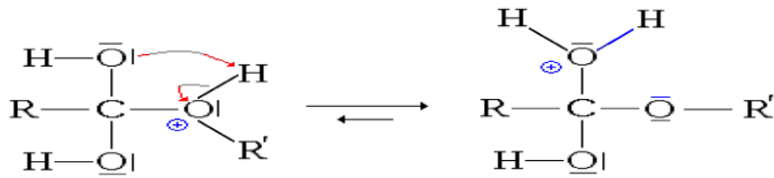
Schéma. I.6 : Transfert du proton ( H^+ ) issu de l'alcool sur un des groupes hydroxyles
