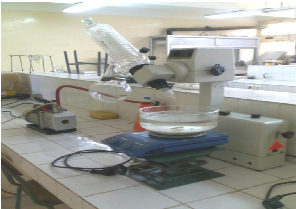
Figure IV.3. Montage utilisé pour évaporer l'ester brut des réactions
