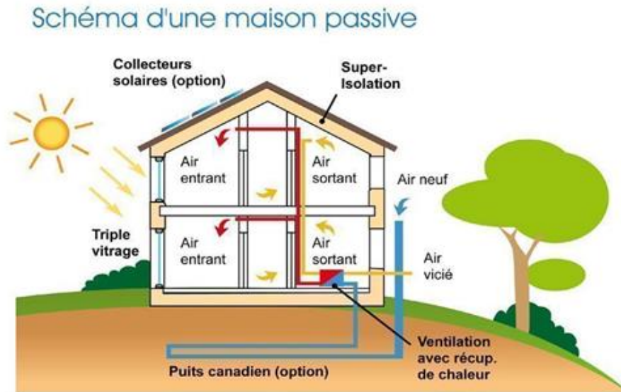
Figure 23 schéma d'une maison passive (source : http://maisonspassives.net/fonctionnement-maison-passive/ )
