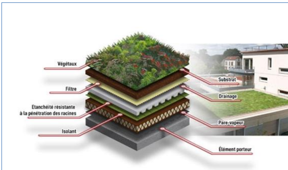
Figure 5 Les composants de toit végétal
