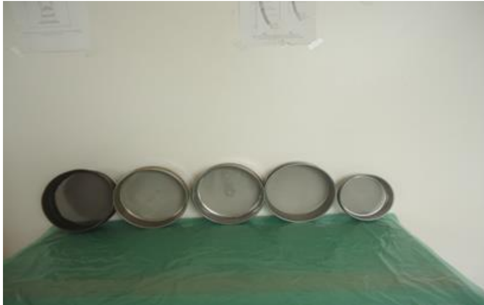
Figure 13 : Des tamis (maille 250 \mu m et 800 \mu m) SRPV EI-Taref
