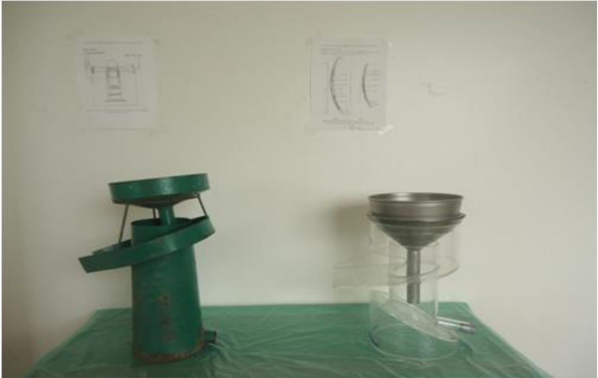
Figure 15 : Appareil d'extraction : Model type FENWICK (SRPV EI-Taref)
