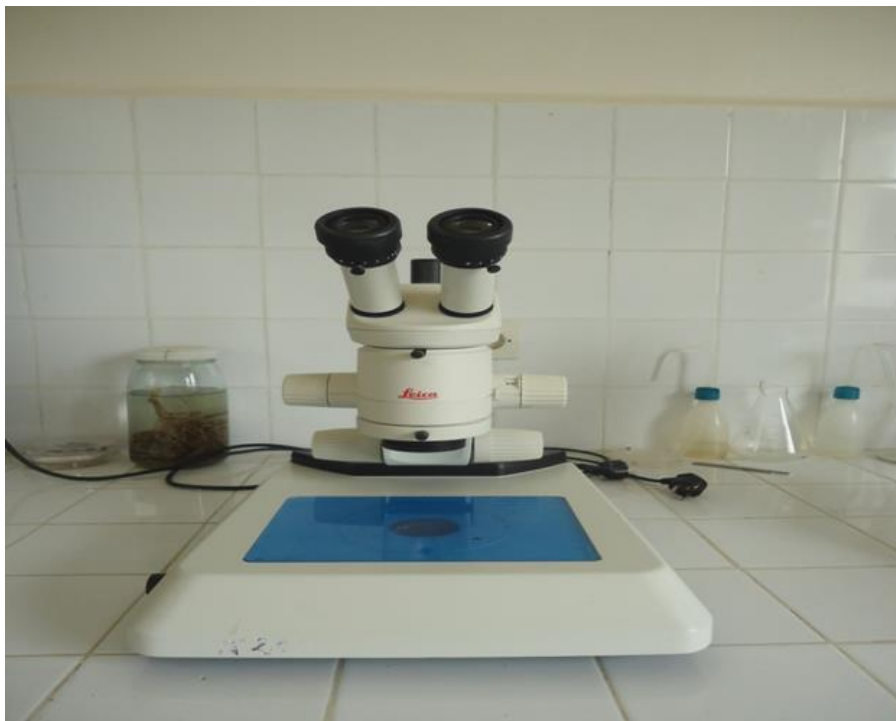
Figure 16 : loupe microscopique à éclairage épiscopique (SRPV EI-Taref)
