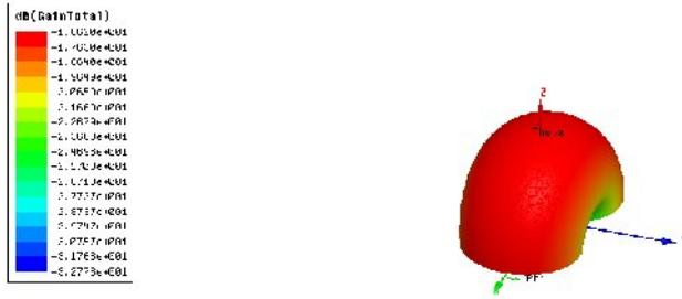
figure IV.38: représentation 3-D du Gain total en dB
