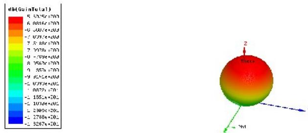
**figure III.9 : Représentation 3-D du Gain total en dB**
