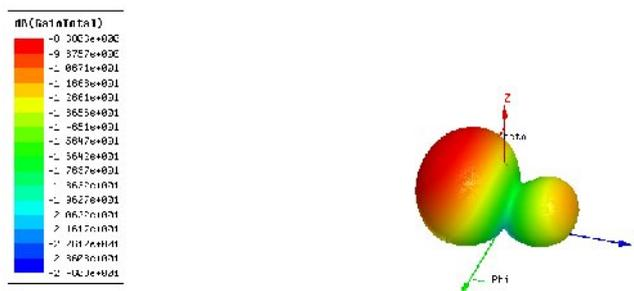
figure IV.18 : Représentation 3-D du Gain total en dB
