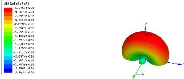
figure IV.33: représentation 3-D du Gain total en dB
