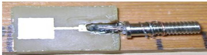
figure V.1 : patch alimenté par ligne avec transformateur résonant à 8.5GHz
