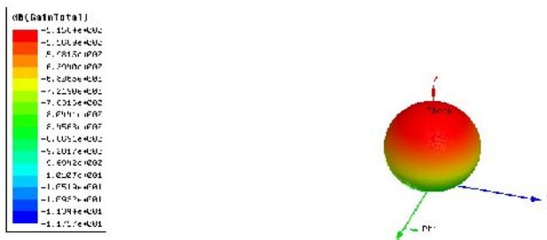
figure III.42 : Représentation 3-D du Gain total en dB
