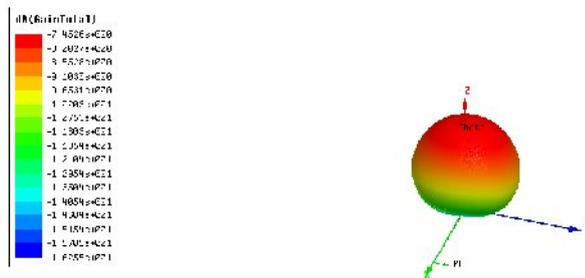
figure IV.28: représentation 3-D du Gain total en dB
