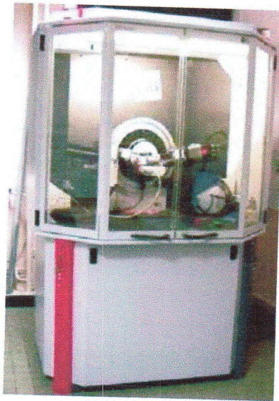
Diffractomètre de marque BRUKER - AXS type D8
