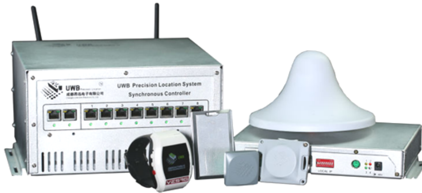
Figure 1.12: Exemple d'un système UWB de localisation et de poursuite de l'entreprise « Chengdu Linkcomm Electronic Co., Ltd » [41].
