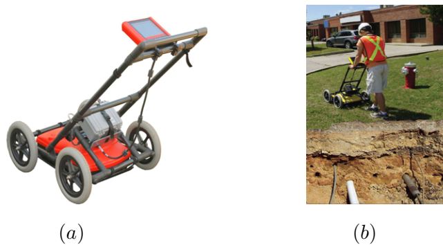
Figure 1.10: Exemple d'un système UWB–GPR (a) le radar LMX-100 [39] (b) utilisation de radar LMX-100 dans un chantier de construction.
