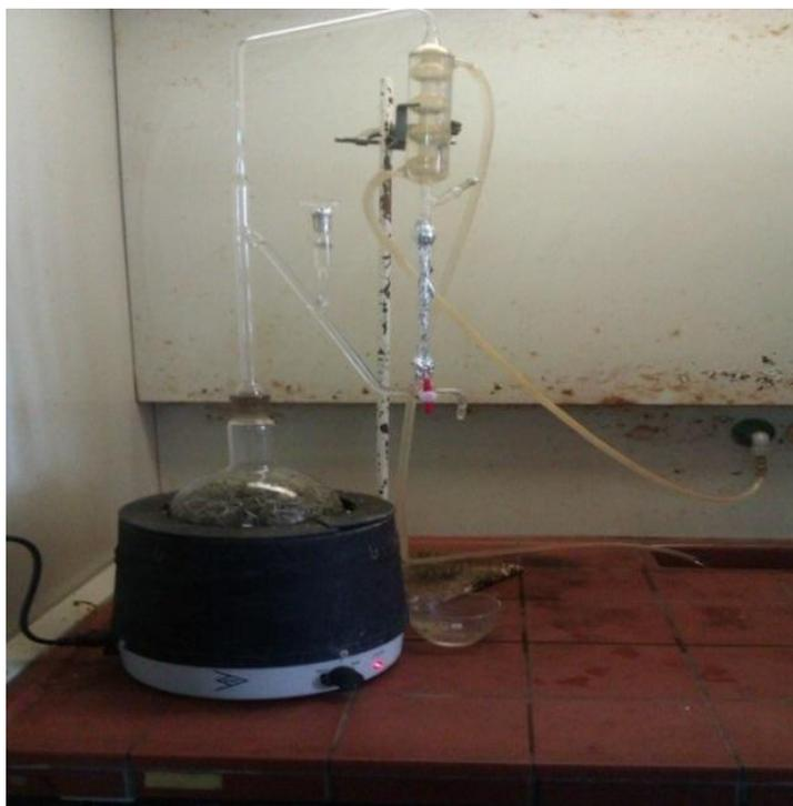
**Figure 03:** Montage d'hydrodistillation utilisé pour l'extraction de l'huile essentielle.
