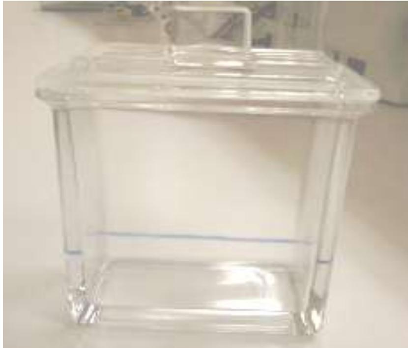
**Fig.12** : La cuve de CCM (Selwa, 2013)
