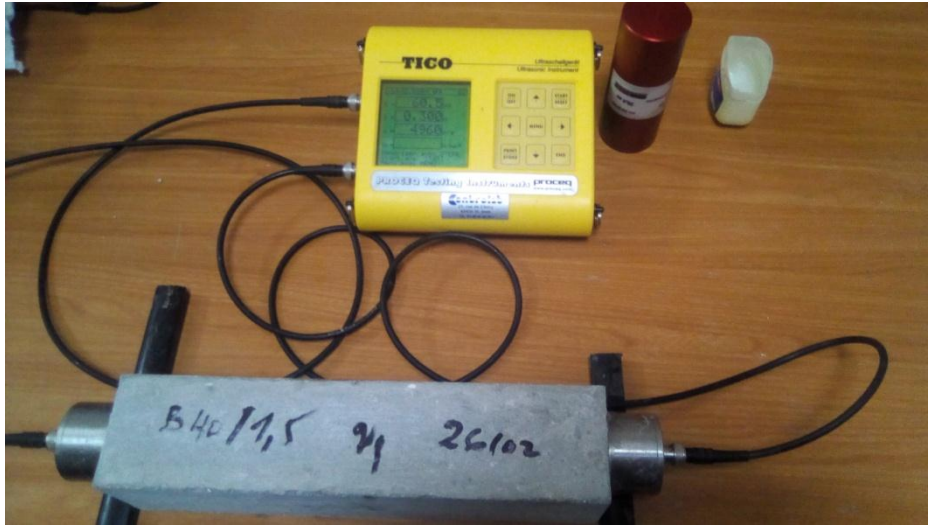
Figure II.4: Appareil à ultrason.
