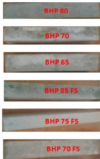
Figure V.15: Aspect extérieur et intérieur après nettoyage des éprouvettes sous l'effet des cycles gel et de dégel.
