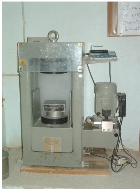
Figure II.2 : La presse utilisée pour la compression.
