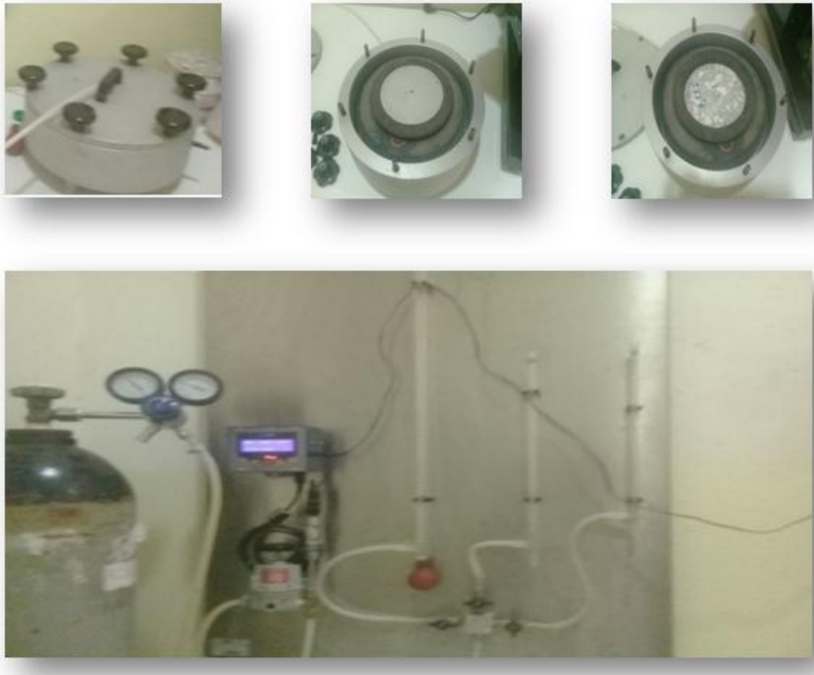
Figure II.7 : appareil de mesure de la perméabilité des gaz employé à l'université de Laghouat.
