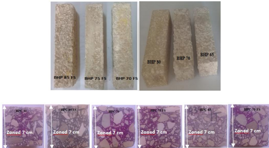
Figure IV.10 : Aspect extérieur et intérieur des éprouvettes après les essais sous une température de 20C°.
