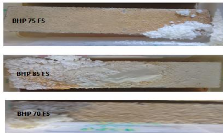
Figure II.17 : Aspect des éprouvettes après un mois d'attaque par un mélange d'acides sous l'effet de température 50c° après avant nettoyage des éprouvettes.
