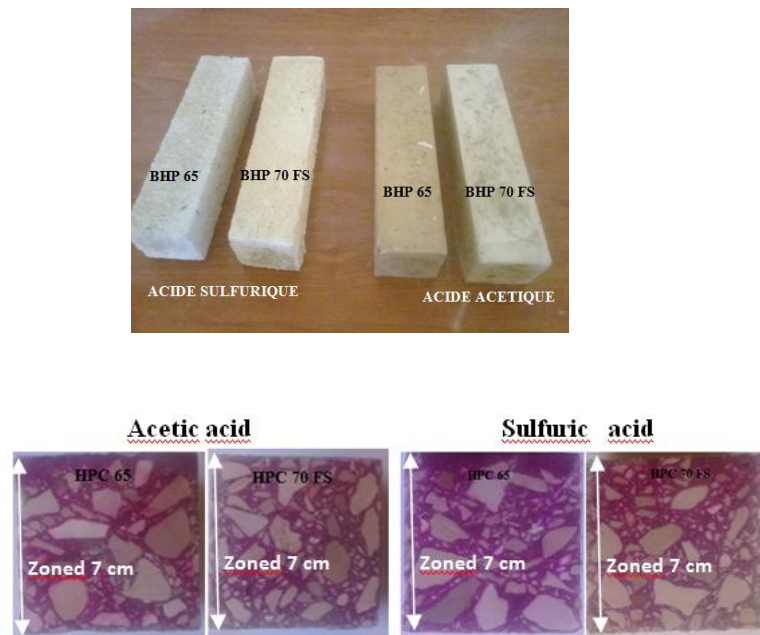
Figure IV.02a : Aspect extérieur et intérieur après nettoyage des éprouvettes.
