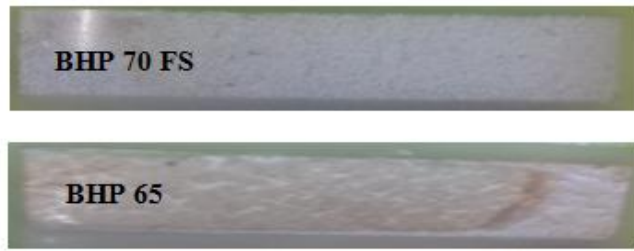
Figure II.11 : Aspect des éprouvettes après un mois d'attaque par l'acide sulfurique avant nettoyage des éprouvettes
