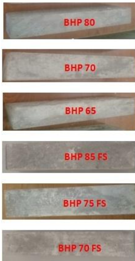
Figure V.01 : Aspect extérieur et intérieur après nettoyage des éprouvettes testées sous une température de 20C°.
