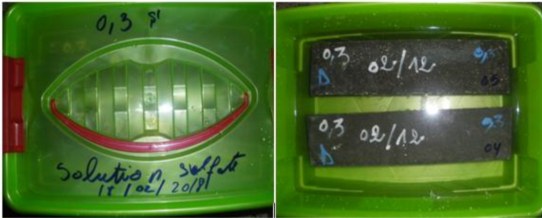
Figure II.19: État des éprouvettes après un mois d'exposition à une solution de 5 % de \text{MgSO}_4 , soumis aux cycles de gel et de dégel.
