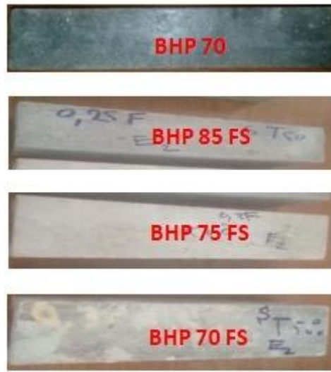
Figure V.24: Aspect extérieur et intérieur après nettoyage des éprouvettes sous l'effet d'une température élevée de 50°C.
