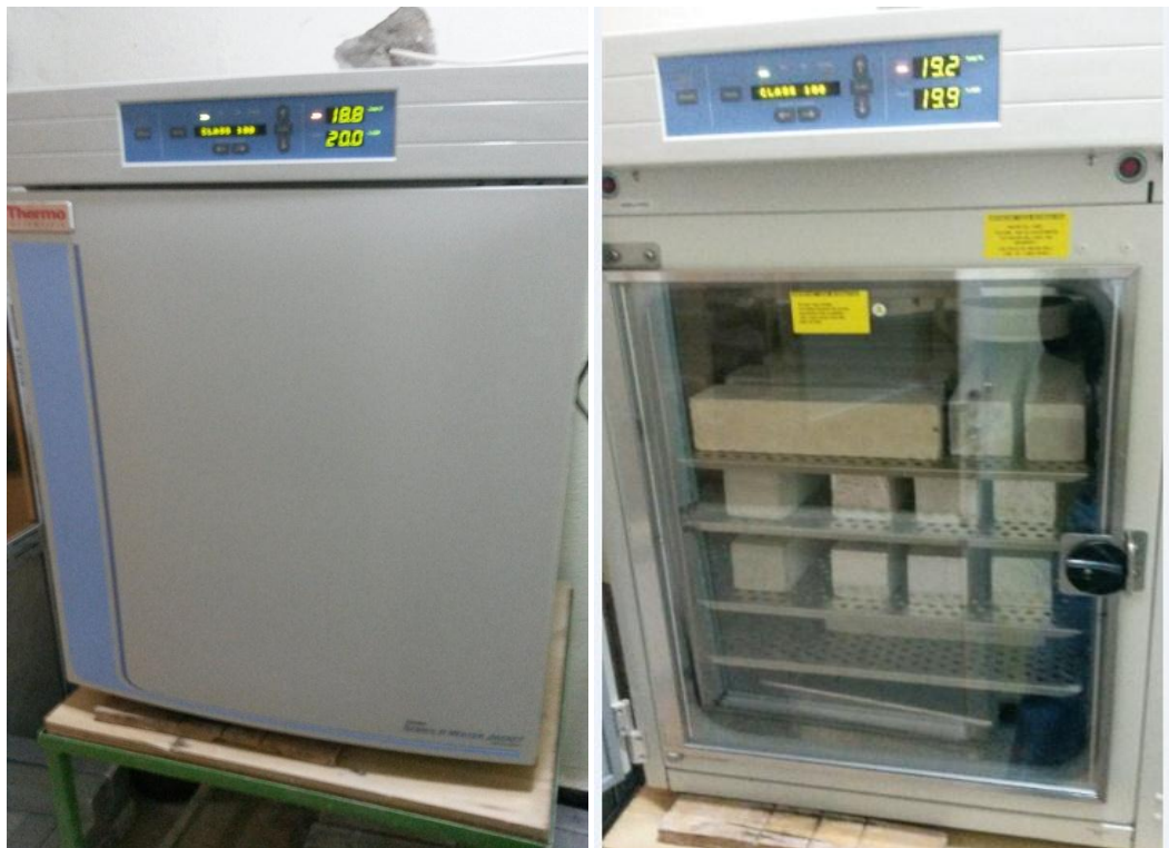
Figure II.09 : L'appareille de carbonatation utilisée
