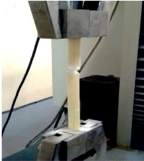
Figure 3-3 : Essais de traction statique uni-axiale
