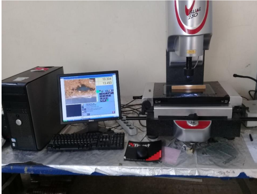
Figure 3-9 : Microscope binoculaire (Visual Gage 250) équipé d'un logiciel (Visual Gage 2.2.0).
