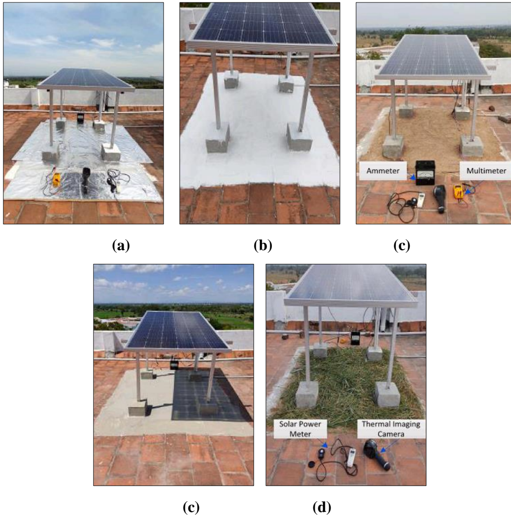
Fig. I.22. Configuration expérimentale pour divers matériaux réflecteurs (a) Aluminium. (b) Peinture blanche. (c) Sable. (d) Ciment. (e) L'herbe. Ganesan et al. [75]
