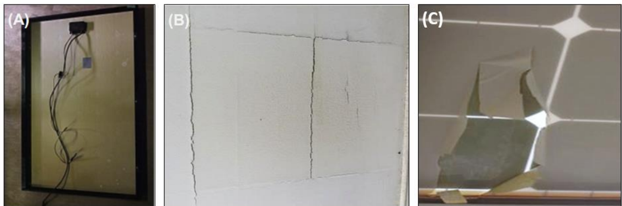
Fig. I.18. Mécanismes de détérioration les plus courants du backsheet : (A) décoloration, (B) fissuration et (C) délaminage [52, 53]
