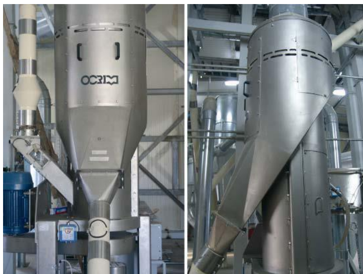
Figure 1.3 : Vis Mouilleuse intensive utilisée dans le groupe Amor Benamor [11].
