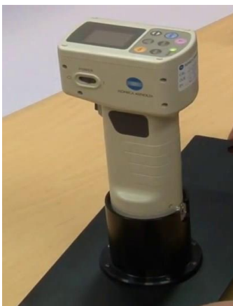
Figure III.13 : Colorimètre Type : Konica Minolta, Modèle : CR - 410.
