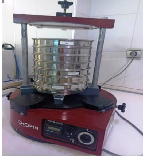
Figure III.14 : Photographie de tamiseuse utilisée pour l'analyse granulométrique de la semoule (ROTACHOC CHOPIN Technologies, Villeneuve la Garenne-France).
