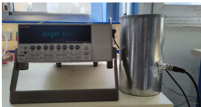
Figure III.9 : Equipement permettant de mesurer la charge électrique : (a) Schéma illustrant le principe de mesure, (b) Photographie du système de mesure (un électromètre Keithley Model 6514 et un Seau de Faraday).
