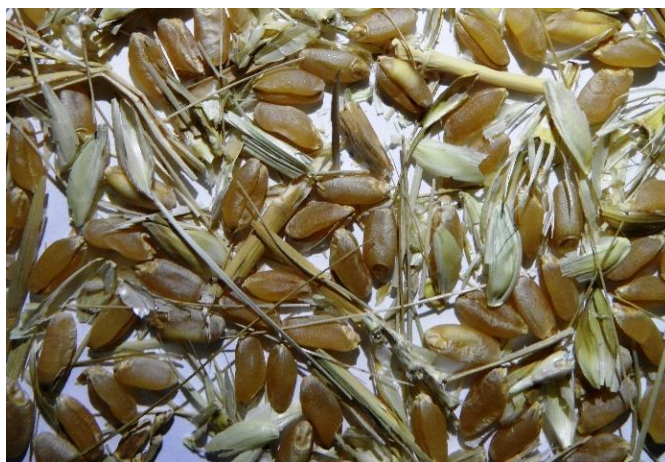
Figure III.2 : Mélange utilisé pour les essais de prétraitement électrostatique (composition : pailles, chaumes et grains du blé dur) [64].
