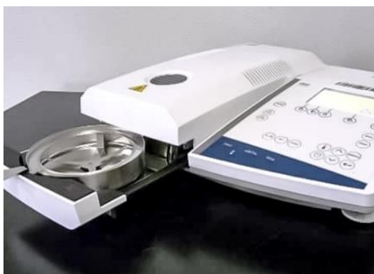
Figure III.12 : Dessiccateur halogène utilisé pour l'analyse du taux d'humidité des échantillons (Model HG63, Mettler Toledo).
