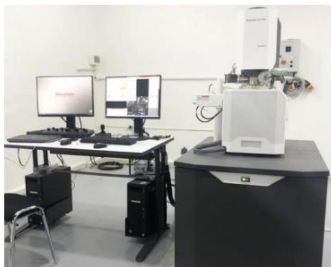
Figure III.4. Microscope électronique à balayage à canon à émission de champ (FEG-MEB) (Quattro S) avec une spectroscopie de rayons X à dispersion d'énergie (EDX).
