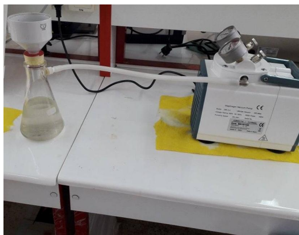
Figure III.3 : Filtration sous vide.
