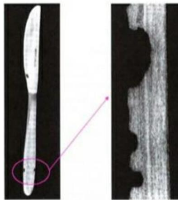
Figure I. 3 : a) Piqûres de corrosion sur un couteau en acier inoxydable (12 % Cr).
