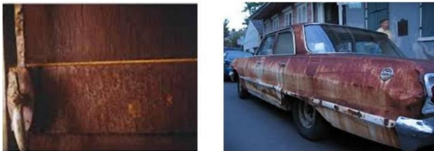
Figure I.2 : Corrosion généralisée : exemple d'une porte et d'un véhicule corrodés.
