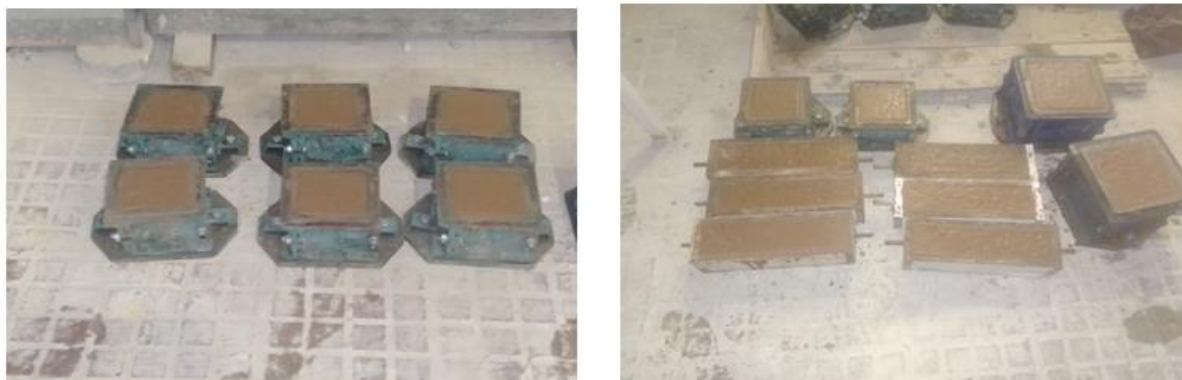
Figure 3 13 : Moulage des éprouvettes de béton.
