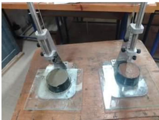
Figure 3 8 : Test de détermination du temps de prise du mortier.
