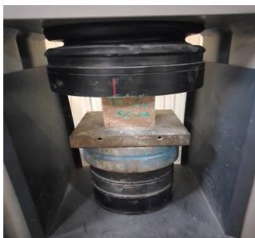
Figure 3 15 : Essai de résistance à la compression à et traction par fendage du béton.
