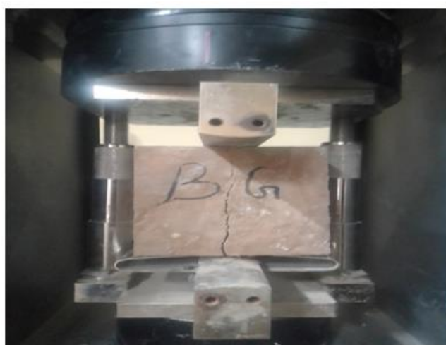
Figure 3 15 : Essai de résistance à la compression à et traction par fendage du béton.
