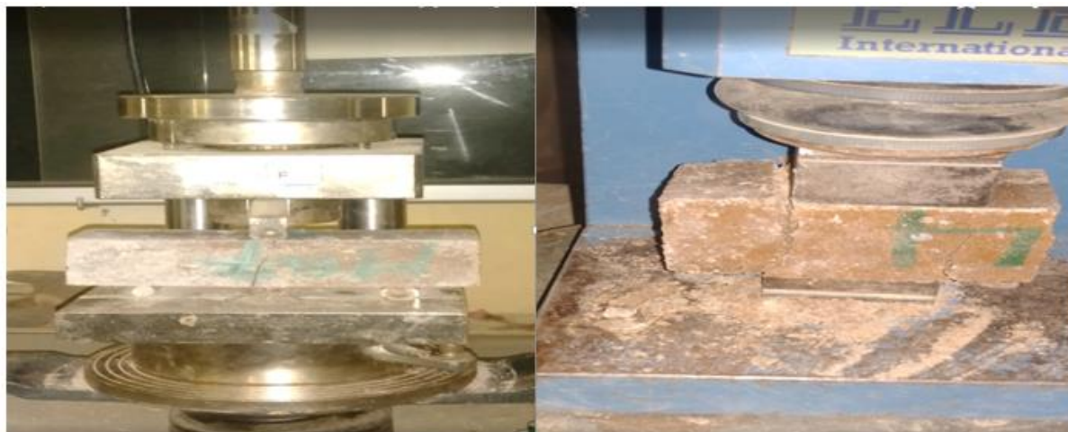
Figure 3 10 : Essai de résistance à la flexion et à la compression du mortier.
