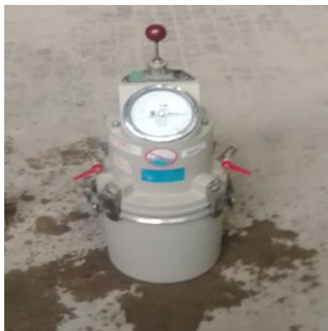
Figure 3 14 : Essai de la teneur en air occlus.
