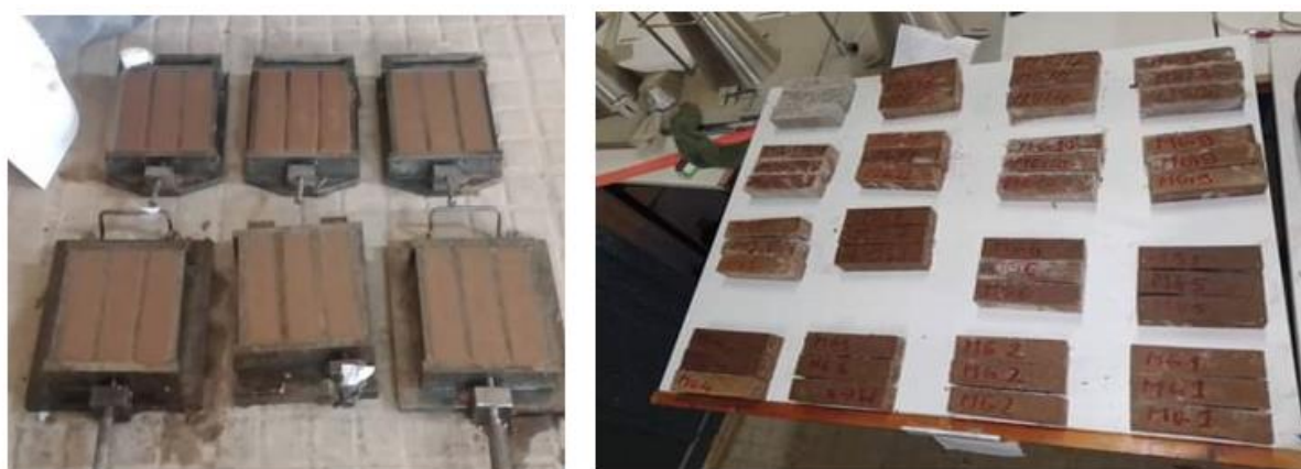
Figure 3 7 : Moulage et démoulage des éprouvettes des mortiers.
