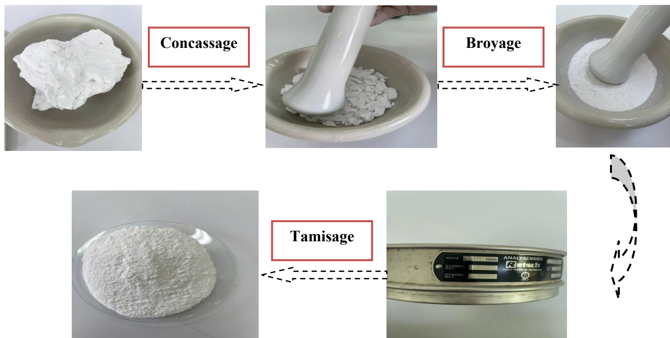
Figure II.6 : traitement préliminaire du Kaolin DD1
