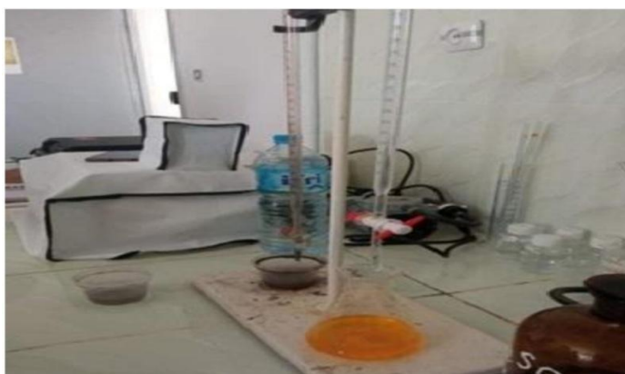
Figure II.4 Montage représentant l'analyse de TAC
