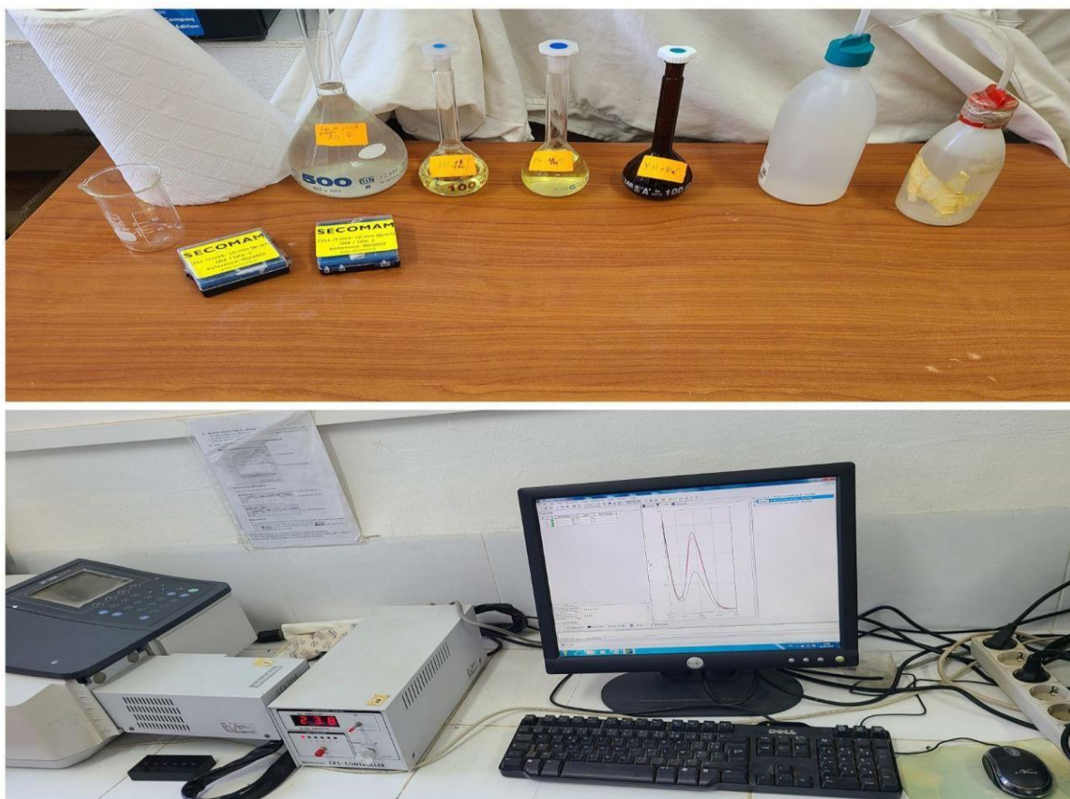
Figure II.9 Image représentant le dosage spectrophotométrique direct de l'eau de Javel
