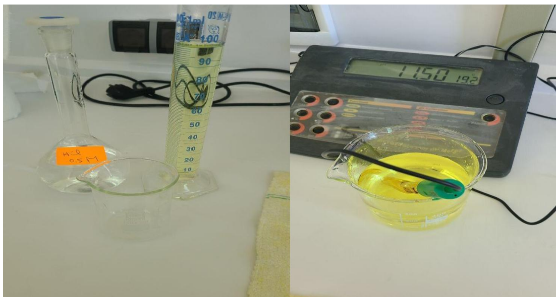
Figure II.8 Image représentant le dosage pH-métrique
