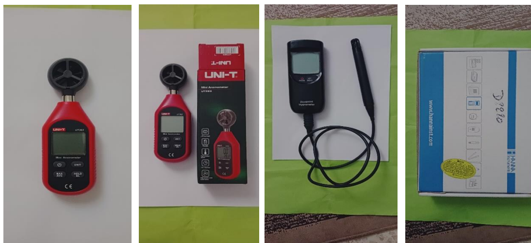
Figure IV.1: Les appareils de mesure utilisés (a) Thermomètre, (b) anémomètre.
