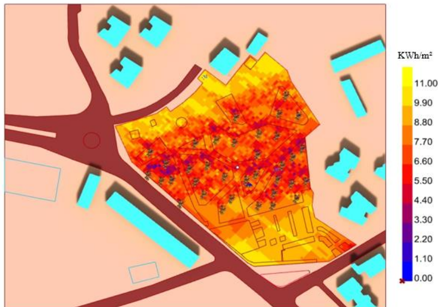
Figure VII.1: Le taux de radiation solaire dans le jardin Esanawbre (en Kwh/m 2 ) simulées avec Grasshoper et Rhinoe pour le 1 Juillet 2024.
