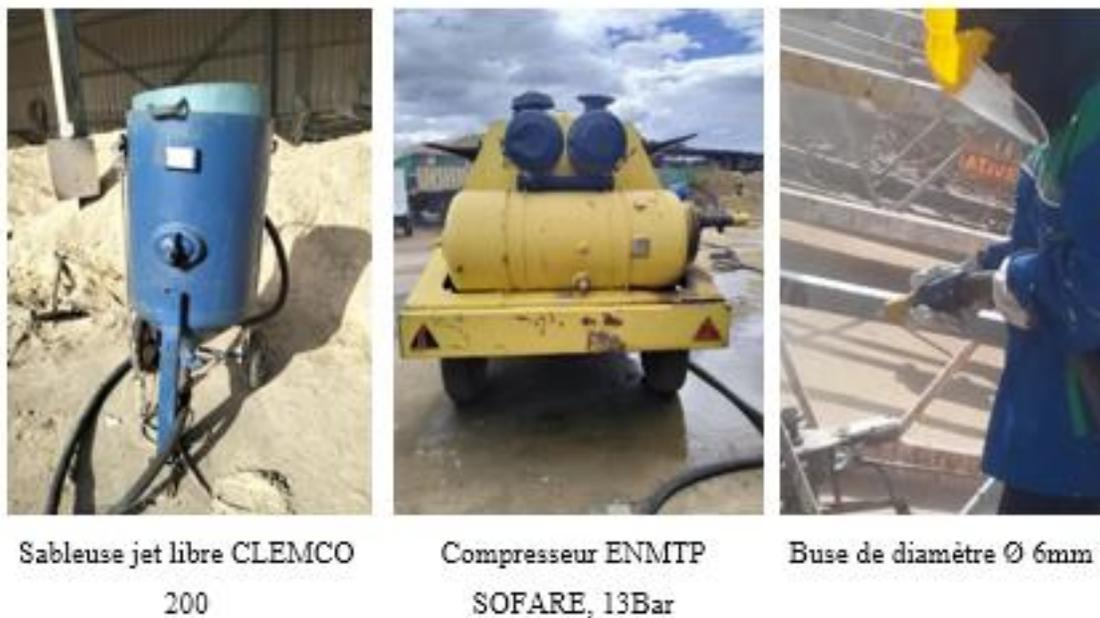
**Figure III. 1. Matériel de sablage utilisé.**
