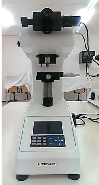
**Figure III. 1. Microduromètre utilisé.**
