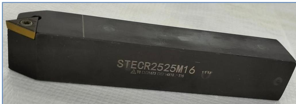
**Fig.II.4 :** Plaquette et porte-outil utilisées.
