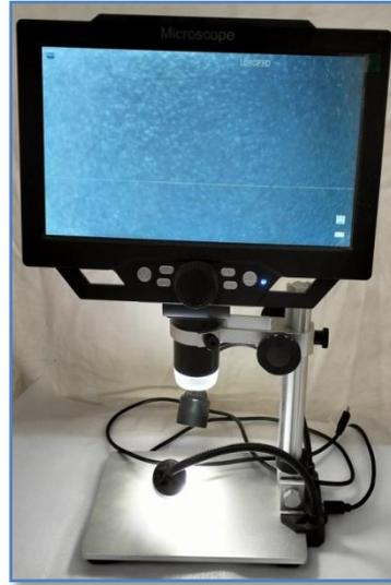
**Fig.II.12** : Microscope digital numérique.
