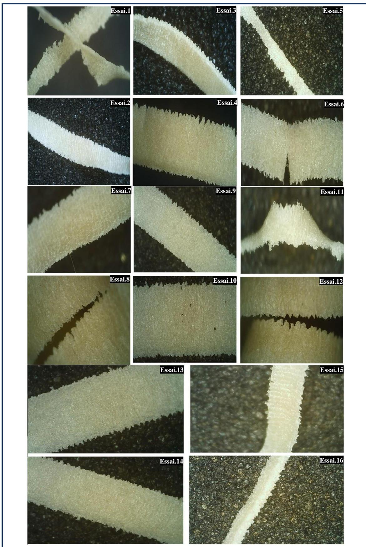
**Fig.III.29:** Forme des copeaux microscopiques.
