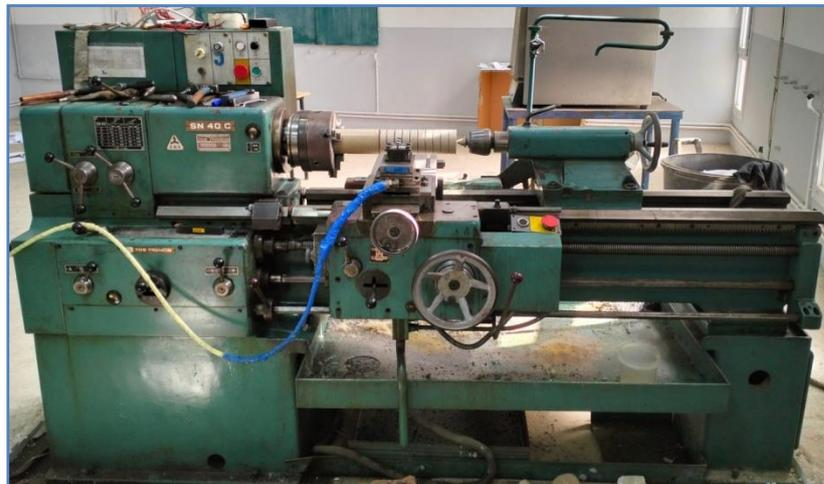
**Fig.II.1** : Tour parallèle modèle SN40C.
