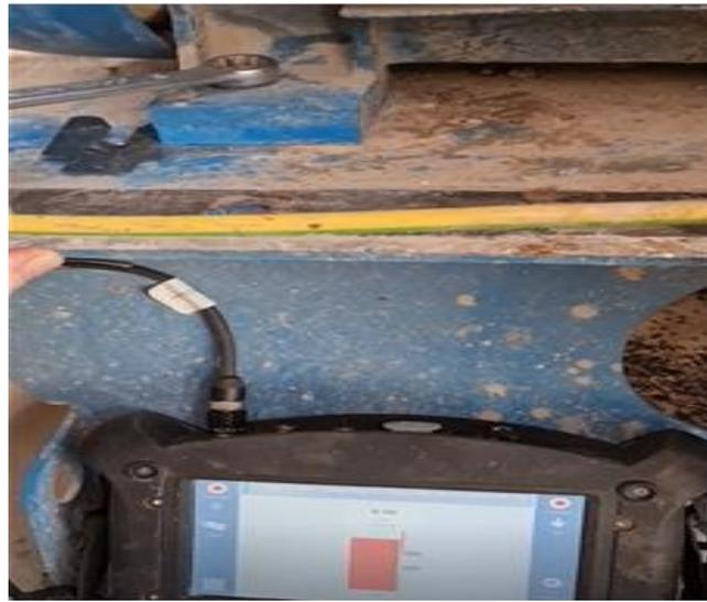
**Figure I. 20:** détection de boîtage par analyse vibratoire.
