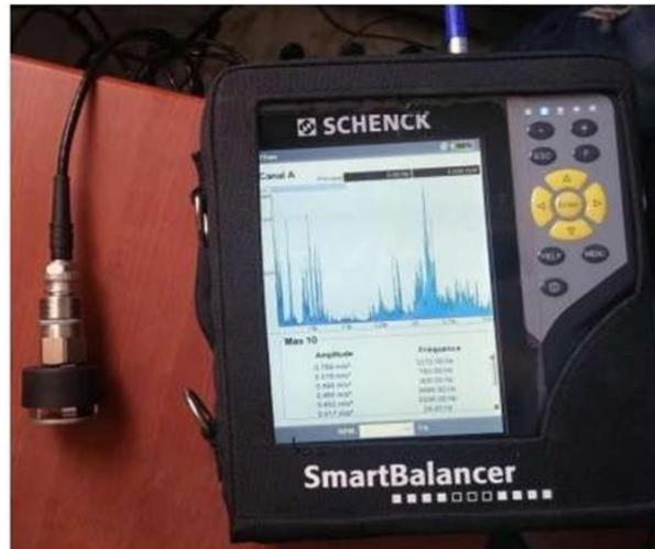
Figure III. 2: l'analyseur de vibrations Schenck.
