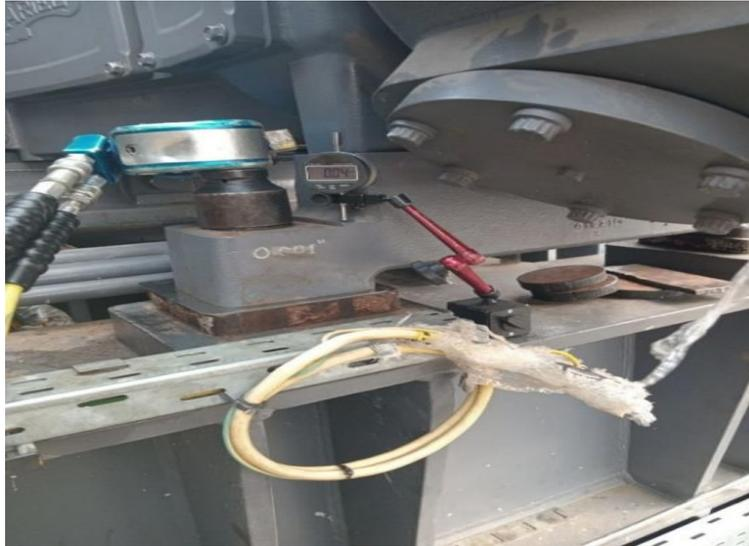
**Figure I. 18:**mesurer de boitage par comparateur a cadran.
