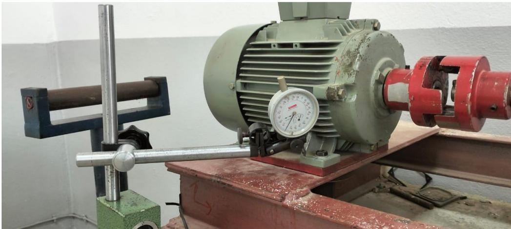
**Figure II. 2:** Mesure du boitage au niveau du pied A par un comparateur à cadran.
