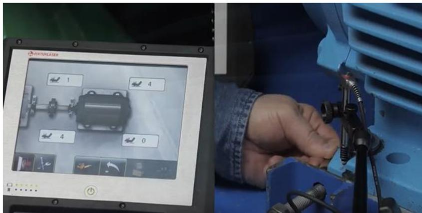
**Figure I. 19:**mesurer de boitage par Systèmes d'alignement laser.
