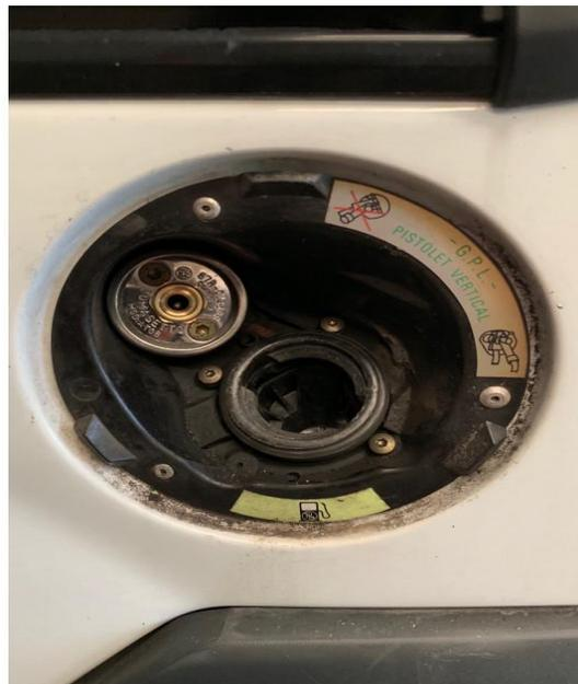
**Figure 13:** Emplacement du dispositif de remplissage.[29]
