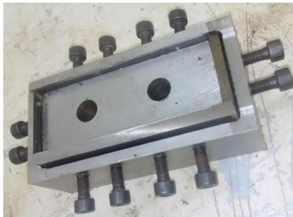
**Figure II. 6:** Dispositif pour la découpe des éprouvettes DENT.
