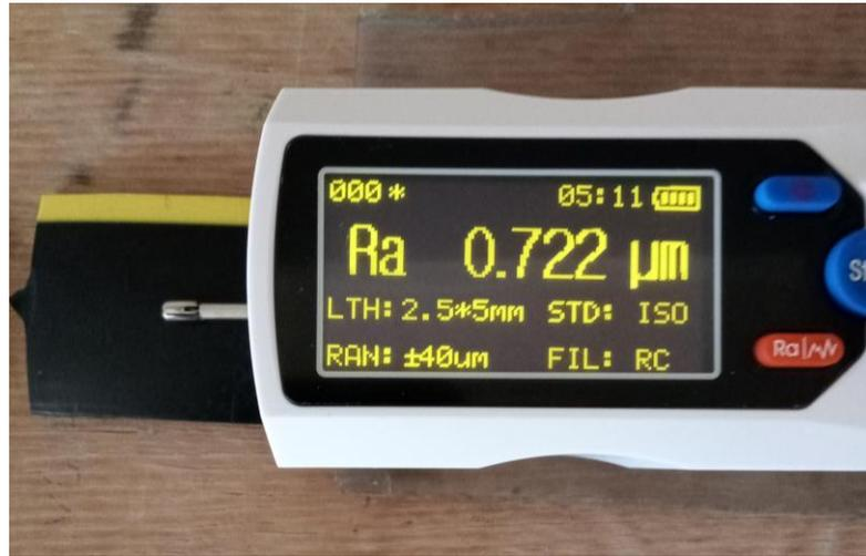
**Figure II.12:** Rugosimètre GOYOJO model TR200.
