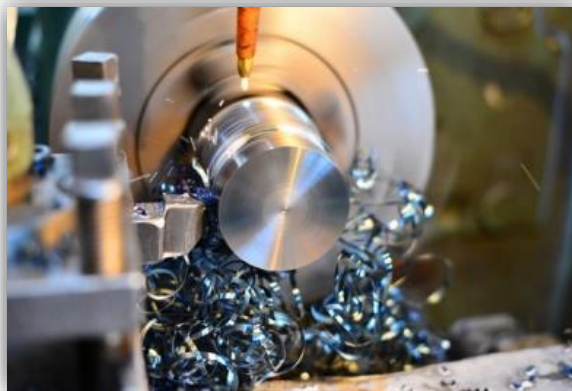
Figure I.2 : Operation d'usinage en tournage dur.[6]
