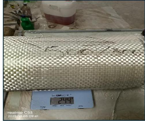
Figure II.6 : Préparation d'une plaque de matériau composite de la
