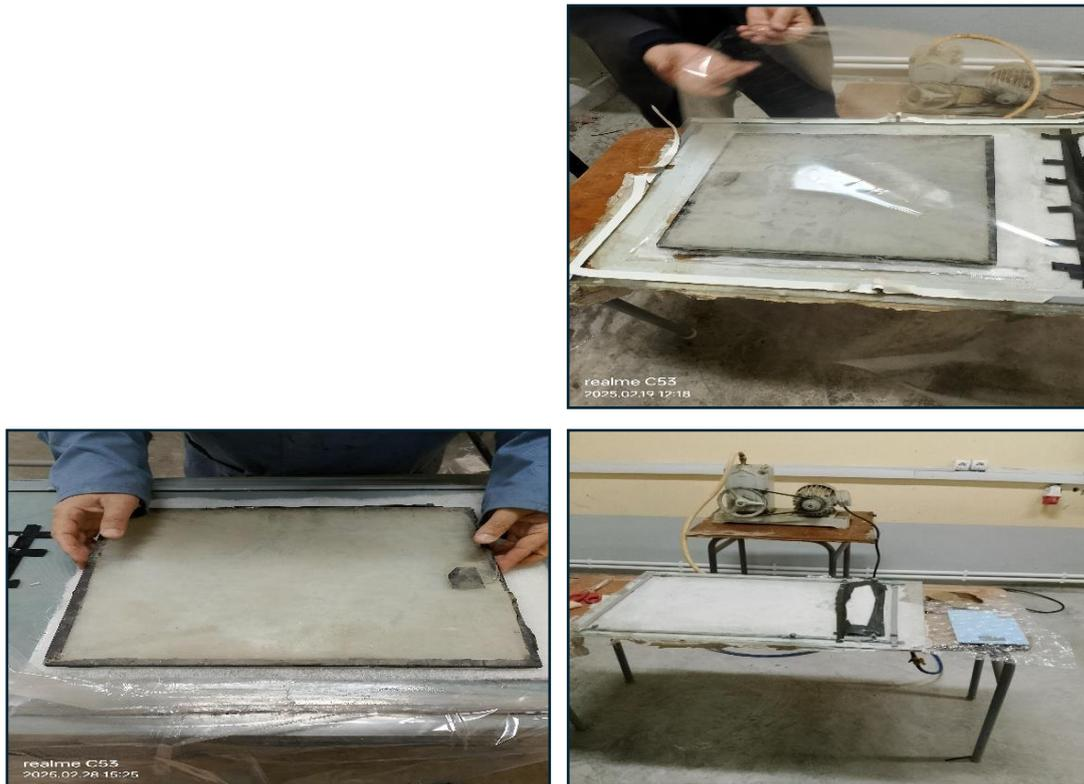
**Figure II.7 :** Préparation d'une plaque de matériau composite de la fibre de Jute. + fibre de verre 300.
