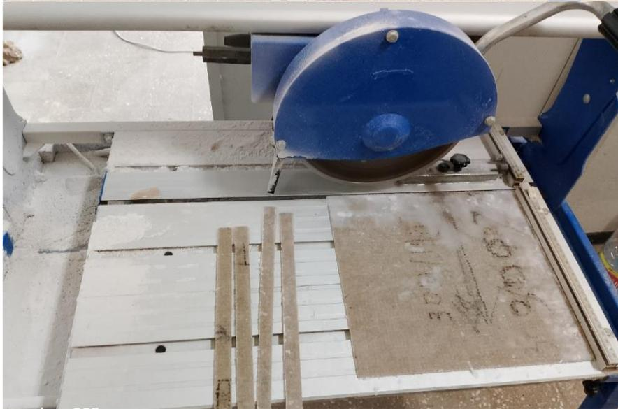
**Figure II.11** : Tronçonneuse à disque diamanté utilisée pour le découpage des plaques composites en éprouvettes.
