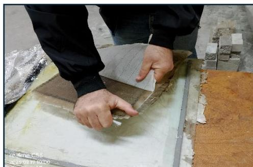
**Figure II.8 :** Démoulée des plaques.
