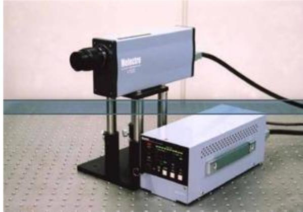
Figure I.9. Vibromètre laser à effet Doppler (LDV) [12].
