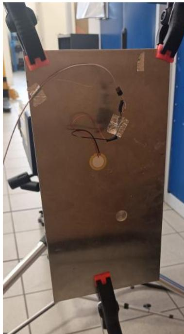
Figure I.5. Excitateur piézoélectrique [40].
