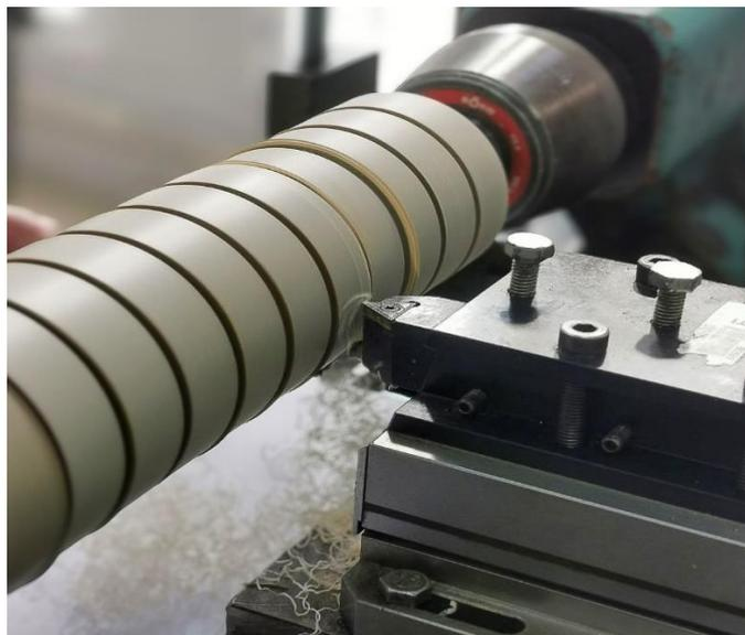
**Figure I.1** : Opération de tournage.
