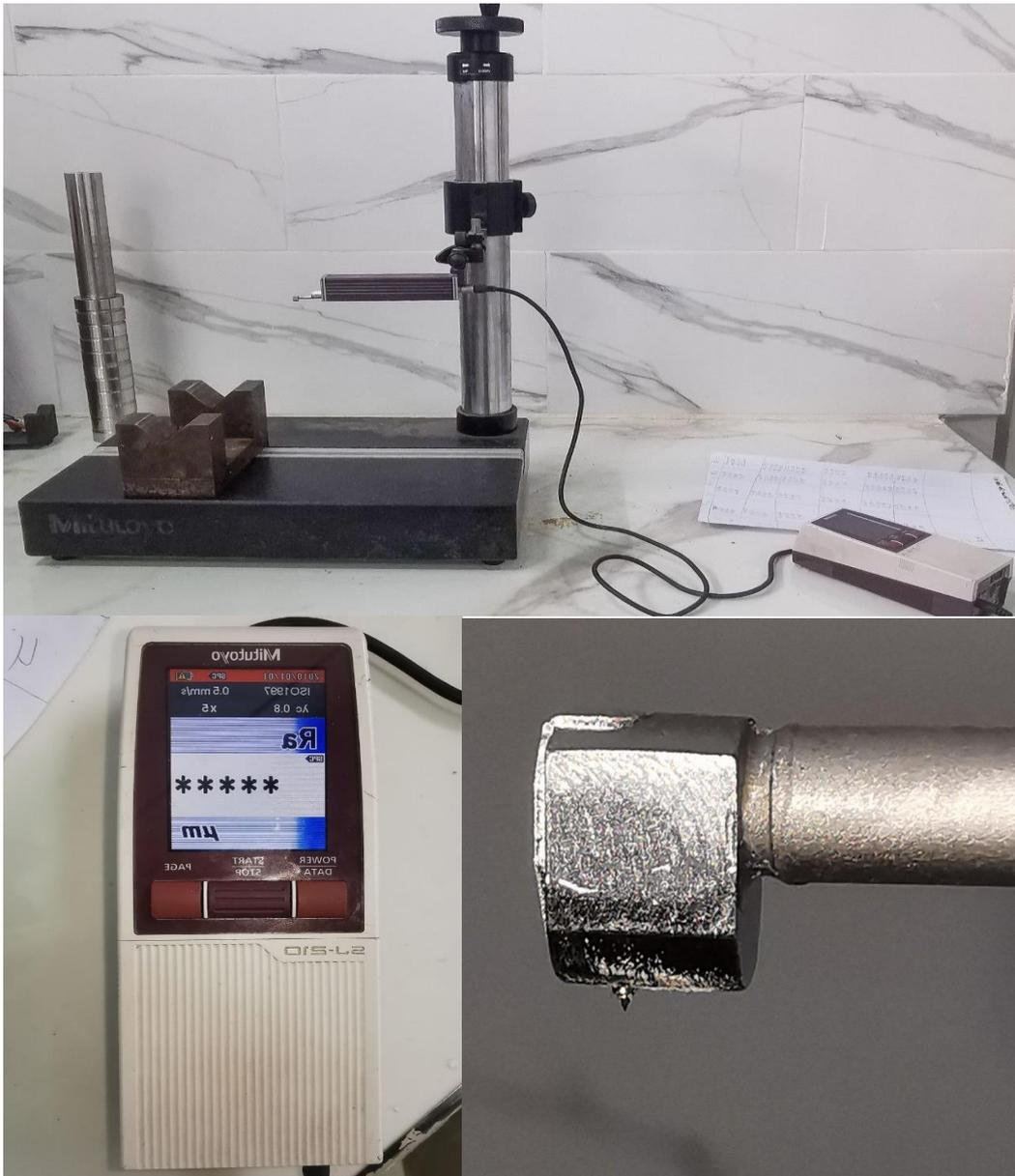
**Figure III.6** Rugosimètre Mitutoyo Modèle SurfTest SJ-210.
