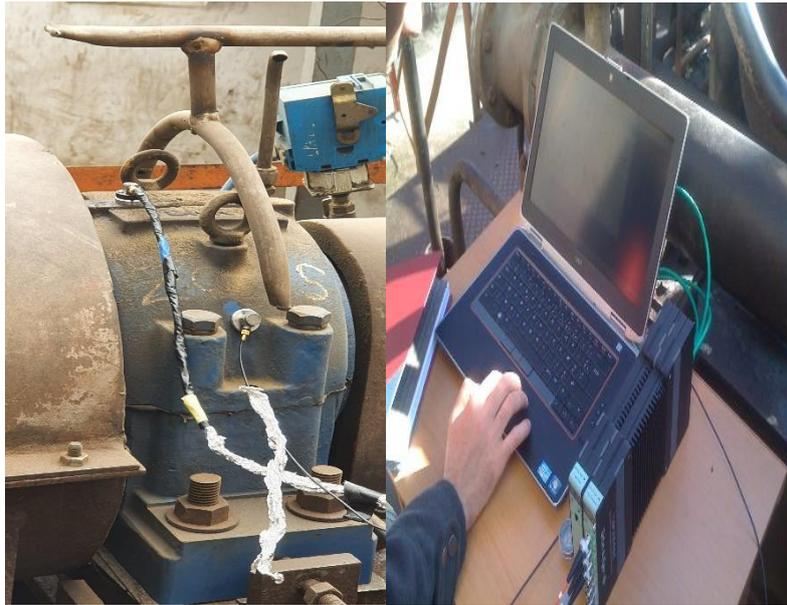
**Figure 3.** (a). Accéléromètres mono axial (industriel) et triaxial, (b). Pulse Labshop et la chaîne de mesure
