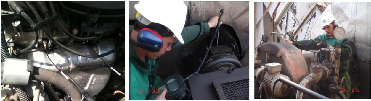
**Figure 6.** Analyse vibratoire d'une machine tournante
