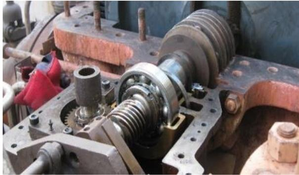
Figure 3. La vis et la roue dentée
