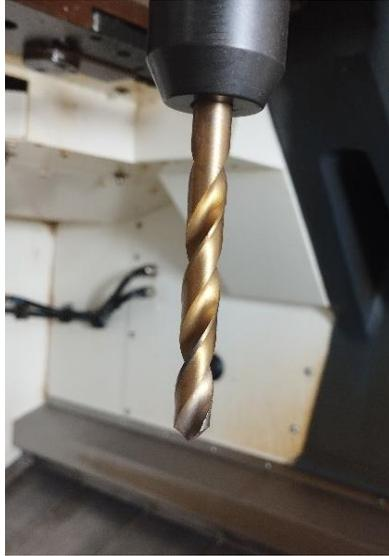
Figure II.8 : foret diamètre 10mm
