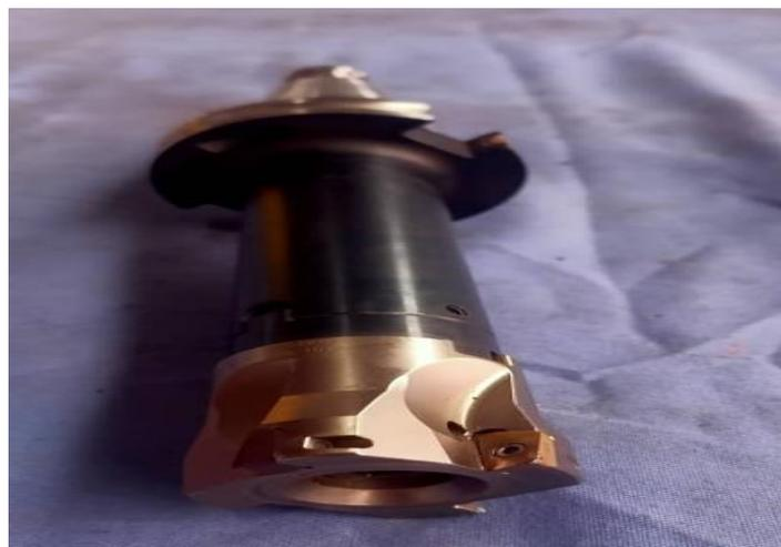
**Figure II.4** : Fraise de surfacage diamètre 50mm
