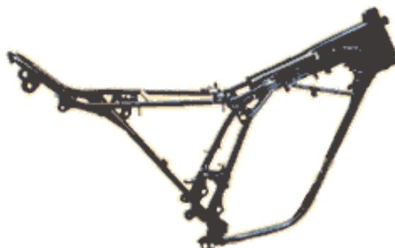
Figure 1. Châssis simple berceau [1]
