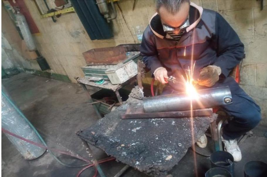
**Figure 15. Soudage au chalumeau**
