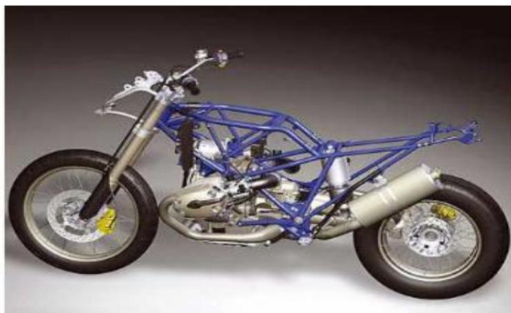
Figure 5. Croquis d'un cadre treillis BMW [1]
