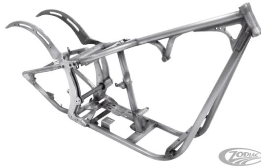
Figure 2. Châssis double berceau [2]
