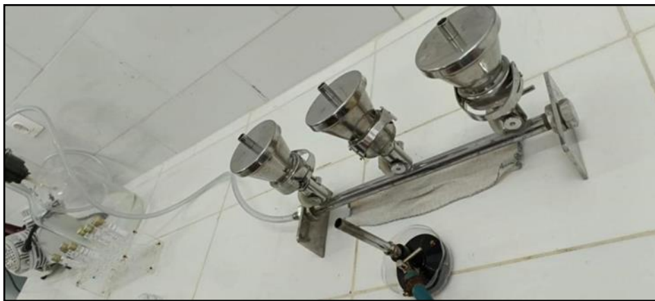
Figure 14 : Rampe de filtration.
