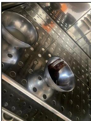
**Figure 21. Détermination de l'extrait sec total (EST) (Cliché personnel, 2025)**
