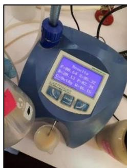
**Figure 19. Mesure de teneur en protéine (par Lactoscan) (Cliché personnel, 2025)**
