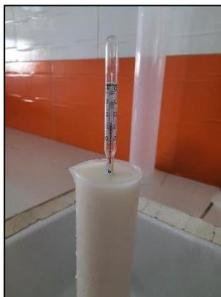
**Figure 18. Détermination de la densité (par thermo-lactodensimètre) (Cliché personnel, 2025).**
