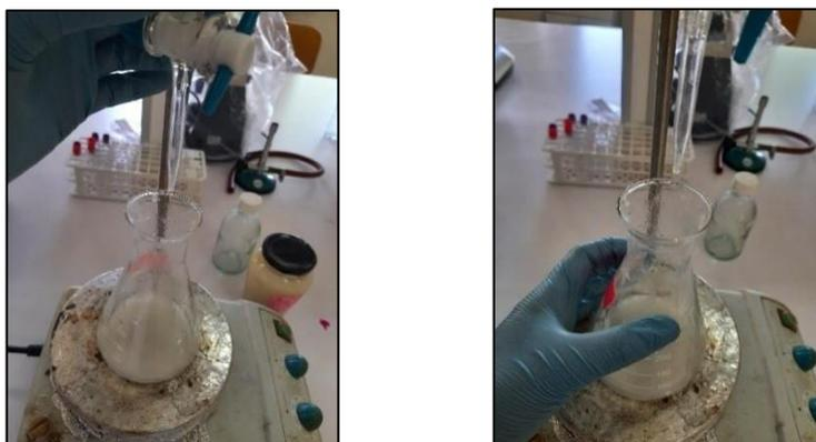
**Figure 17. Détermination de l'acidité titrable (Cliché personnel, 2025)**
