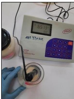
Figure 16. Mesure du pH et la température par pH mètre (Cliché personnel, 2025).
