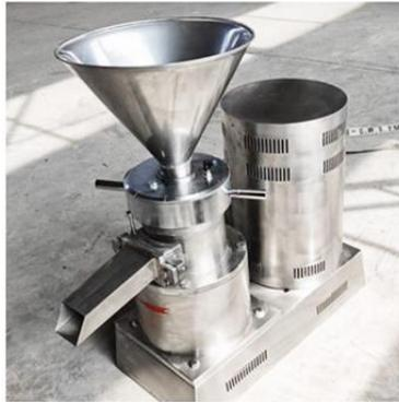
**Figure 7. Broyeur colloïdal pour lait d'avoine (Beyond, 2012).**
