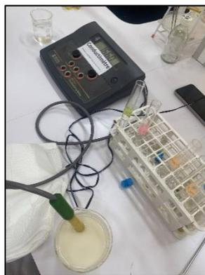
**Figure 22. Mesure de la conductivité (par la Conductimètre) (Cliché personnel, 2025).**
