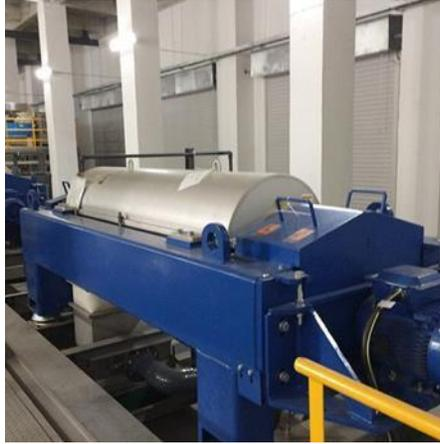
**Figure 9. Séparateur centrifuge à décanteur (Beyond, 2012).**
