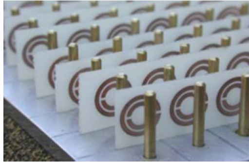
Figure II.2 : Structure proposée par D. Smith (SRR + Tige) présentant Un milieu doublement négatif [43]
