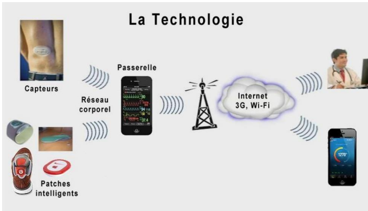
Figure II.1 : Un système de Bio-télémétrie Numérique sans fil qui surveille les signes vitaux à l'aide d'un téléphone intelligent [33].
